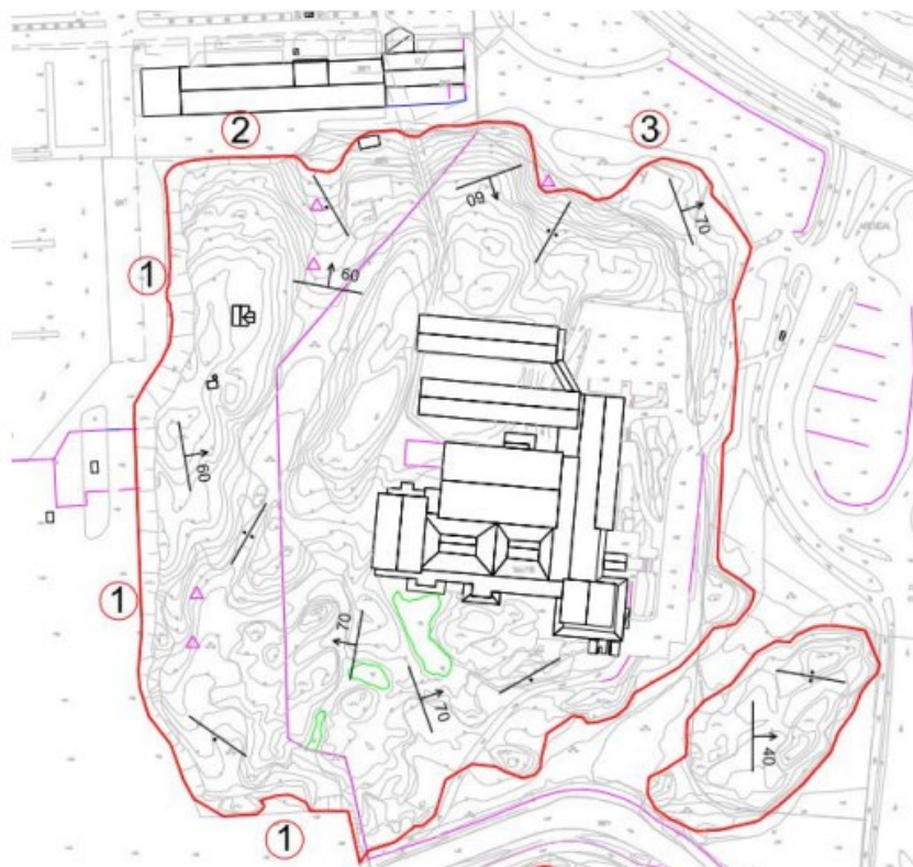
Bild. Planritning från tidigare genomförd bergteknisk utredning, Geotekniskt PM 2024-01-17 (ursprungligen från Bergab, 2012-02-22) med markerade slänter som ingår i kontrollprogram.
